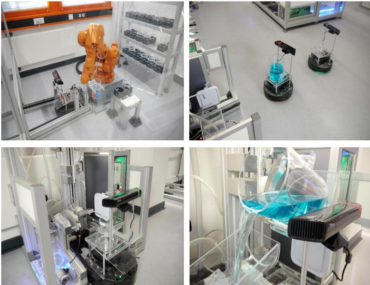
Abbildung 10: o.l.: Produkteinlagerung; o.r.: Roboter fährt in Station ein, um Produkt abgefüllt zu bekommen; u.l.: Warteschlangenbildung vor Station; u.r.: Entleeren von großem Becher durch Hebevorrichtung
