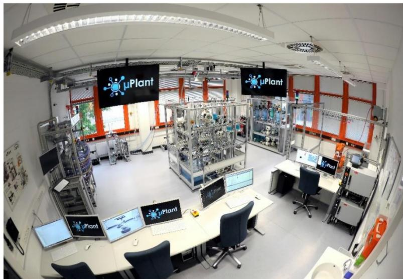
Abbildung 9: Modellfabrik  $\mu$ Plant: Im Vordergrund ist der Leitstand, im Hintergrund sind die verschiedenen Produktionseinrichtungen (Prozessinseln, Fertigungszelle, Abfüll- und Entleerstationen, Hochregallager) zu sehen
