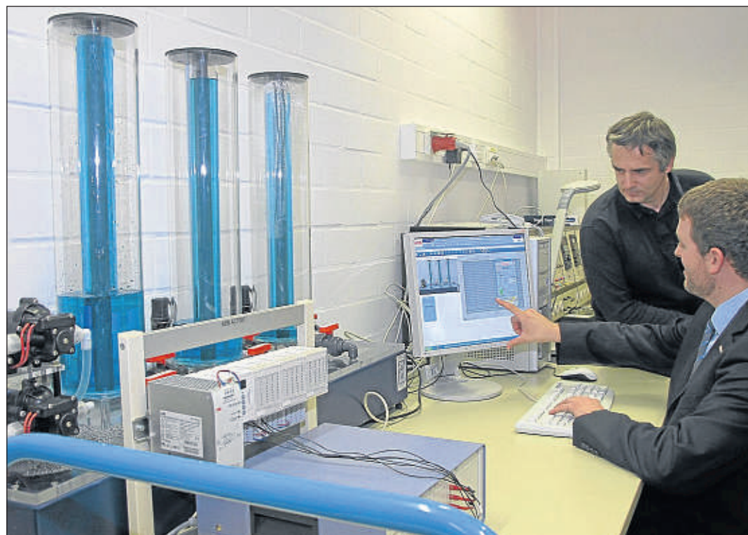
Laborversuch: Laboringenieur Axel Dürrbaum (auf dem Tisch sitzend) und Doktorand Andreas Geiger demonstrieren einen Laborversuch zur Tankfüllstandsanzeige. Foto: Weisker
