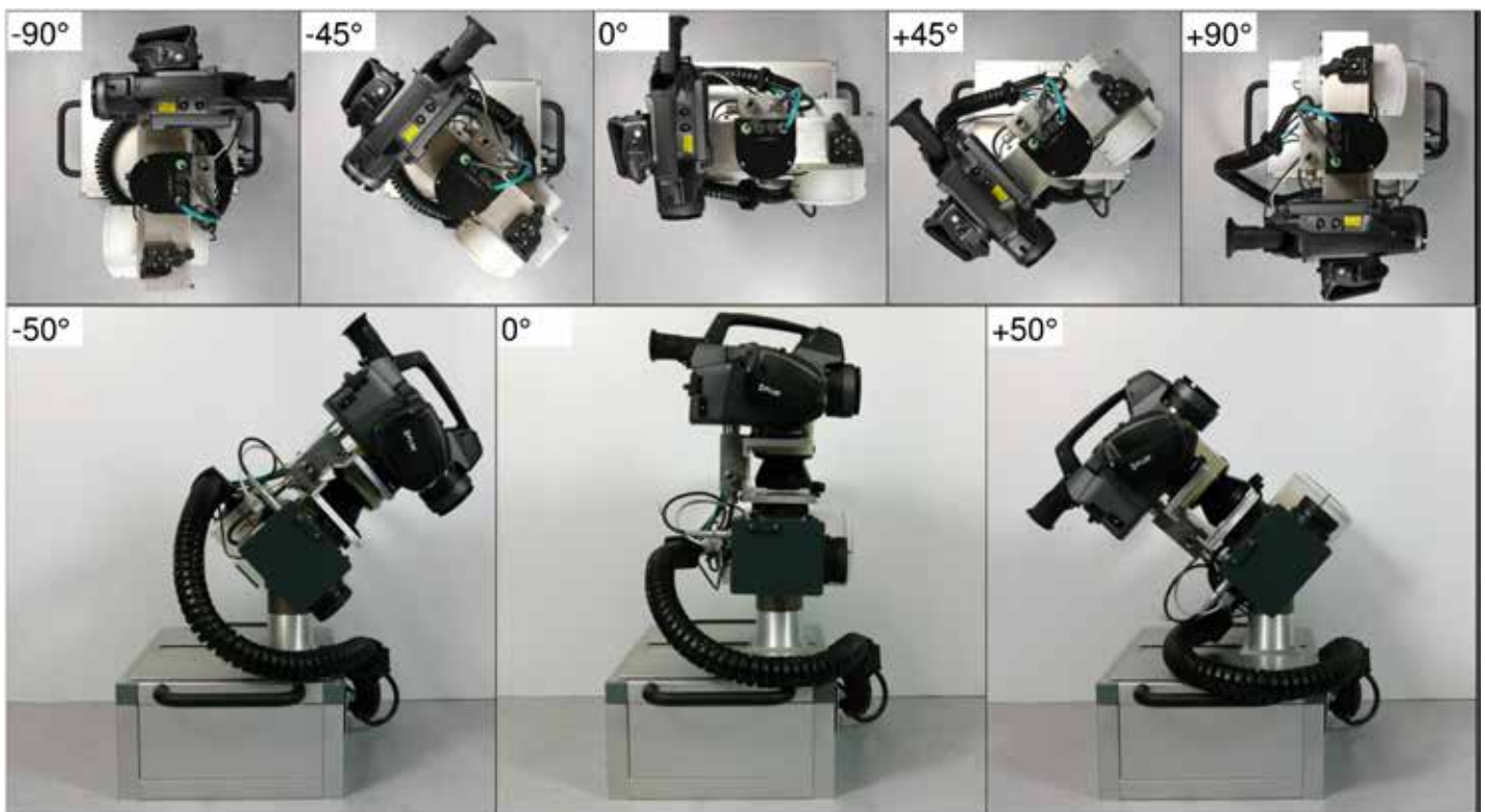
Schwenkbereich (Draufsicht oben) und Neigebereich (Seitenansicht unten) des Sensorsystems.
