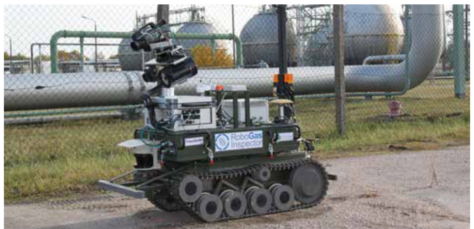
Bild: Der RoboGas Inspector besteht aus drei Baugruppen: Kettengetriebene Fahrplattform, Navigationsmodul und Inspektionsmodul.
